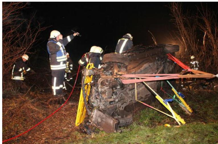
Weil der Fahrer an den Beinen eingeklemmt war, musste das Fahrzeug an mehreren Stellen aufgeschnitten und schließlich hydraulisch „gestreckt“ werden.
